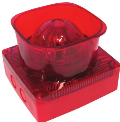
O sinalizador é um dispositivo de alarme com sirene piezoelétrica de alta intensidade, strobe (conjunto de 12 pilotos tipo LED de alto brilho) e baixíssimo consumo para operação em 24 volts. Possui proteção contra inversão de polaridade e pode ser usado diretamente em linhas de comando supervisionadas. Possui grau de proteção IP65, podendo ser utilizado em áreas externas com ocorrência de chuva.
